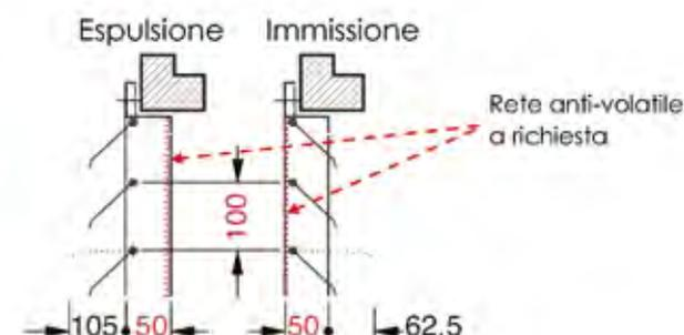
Telaio 12/10 mm: acciaio zincato Alette: alluminio 6/10 mm
