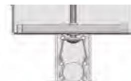
Collegamento del diffusore con giunto lineare nel collegamento seriale
