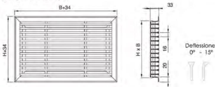
Griglia pedonabile con telaio perimetrale in acciaio zincato o in alluminio, serranda di taratura e cestello raccogli-polvere
