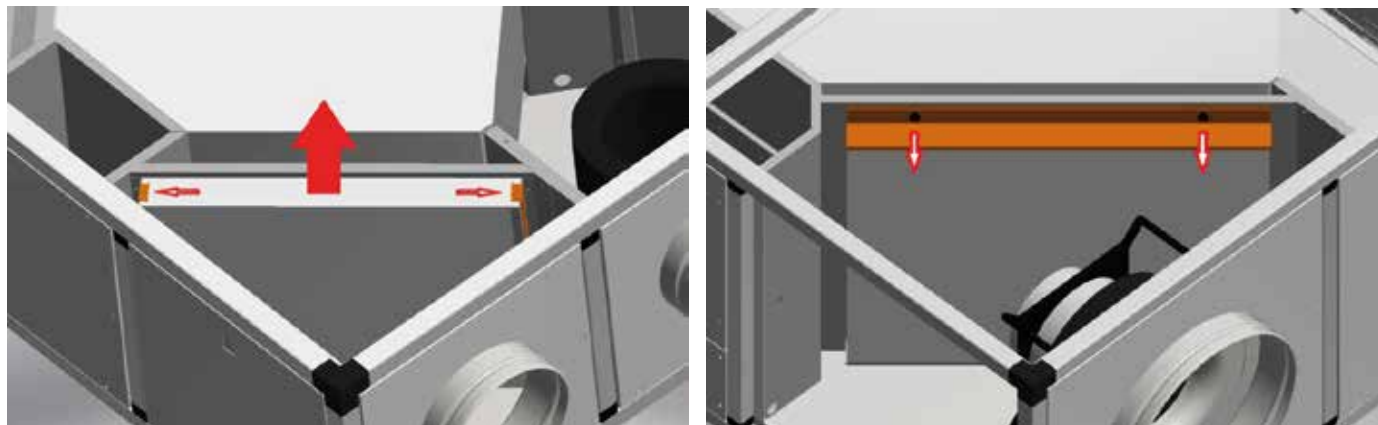
Figura 6 – Sequenza operazioni per rimuovere i filtri nelle unità di taglia piccola: dopo aver spostato (immagine a sinistra) o rimosso (immagine a destra) i fermi filtro, sfilare i filtri dalle guide.
