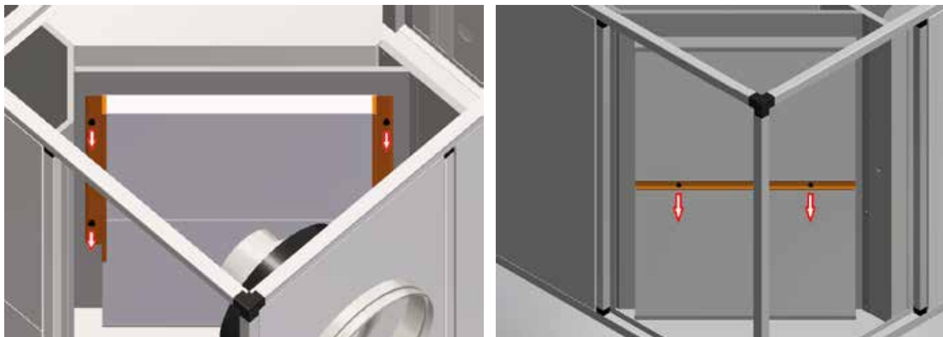
Figura 7 – Sequenza operazioni per rimuovere i filtri nelle unità di taglia grande: togliere i fermi filtro (dopo aver svitato le relative viti/pomelli di fissaggio) ed estrarre i filtri dal coperchio frontale o dai pannelli laterali.
