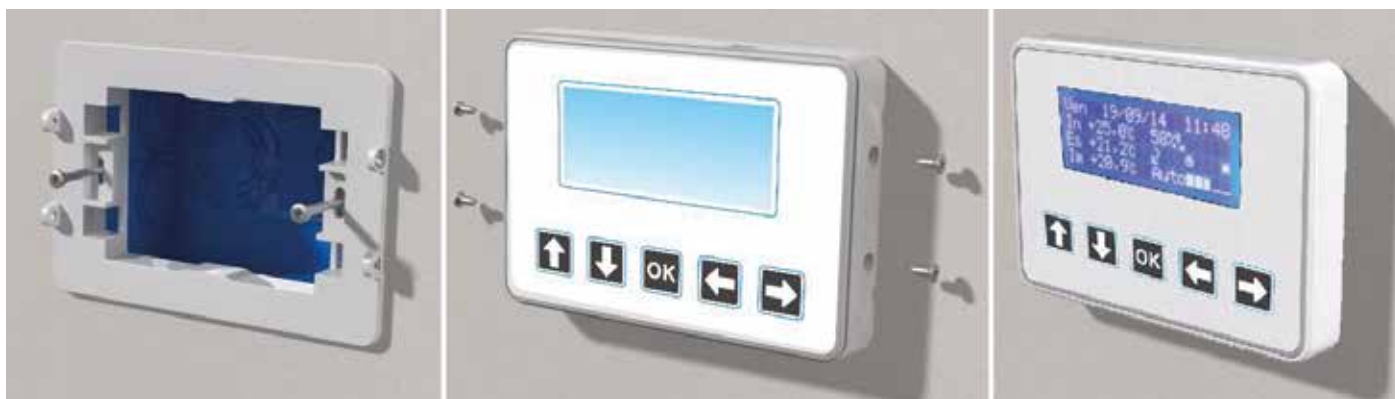
Figura 2 - Sequenza installazione controllo remoto LCD
