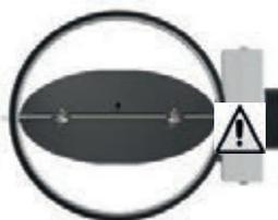
**Installazione in condotto orizzontale, in diagonale o verticale, l'importante è che l'asse di rotazione della pala sia sempre in posizione orizzontale.**
