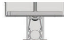
Collegamento del diffusore con giunto lineare nel collegamento seriale
